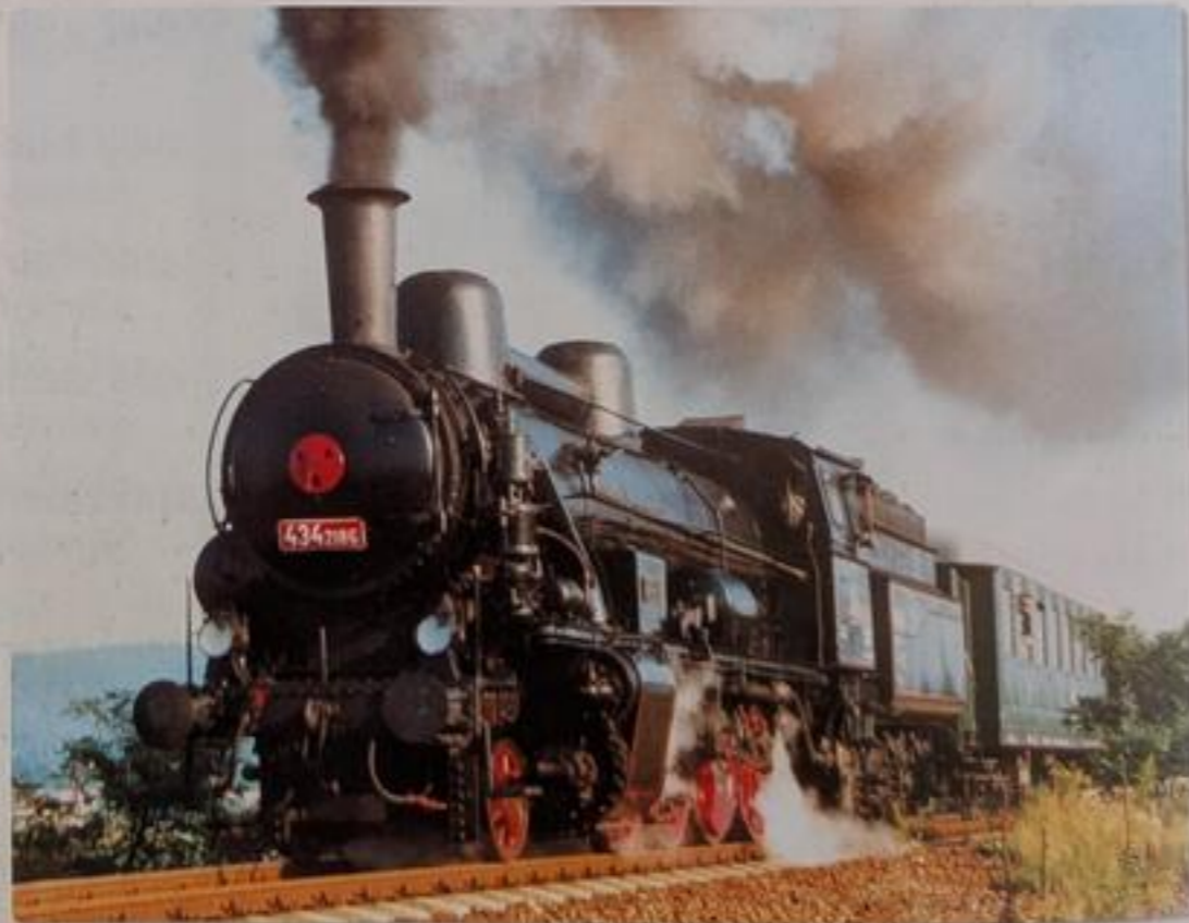
Parní lokomotiva vyrobená pro Československé státní dráhy firmou Českomoravská-Kolben-Daněk. Lokomotiva vážila přes 60 tun a dosahovala rychlosti 60 km/h.
