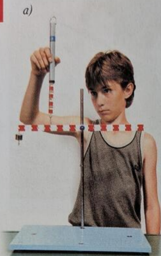
Obr. 1.87 Rovnovážná poloha páky, na kterou působí dvě síly na stejné straně od osy otáčení
